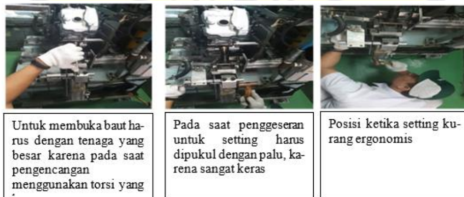
Gambar 6. Proses Pengecekan Engine Noise sebelum perbaikan Muffler .
