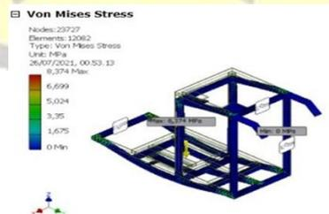
Gambar 7. Tegangan yang terjadi pada struktur frame
