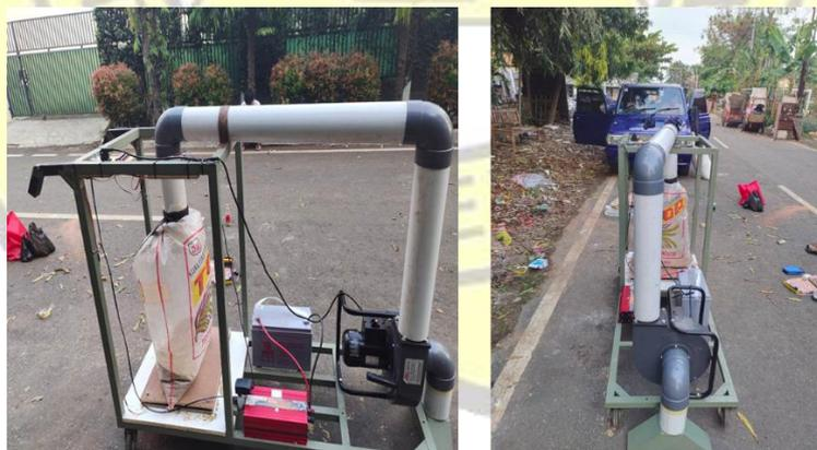
Gambar 18. Alat penyedot gabah kering
