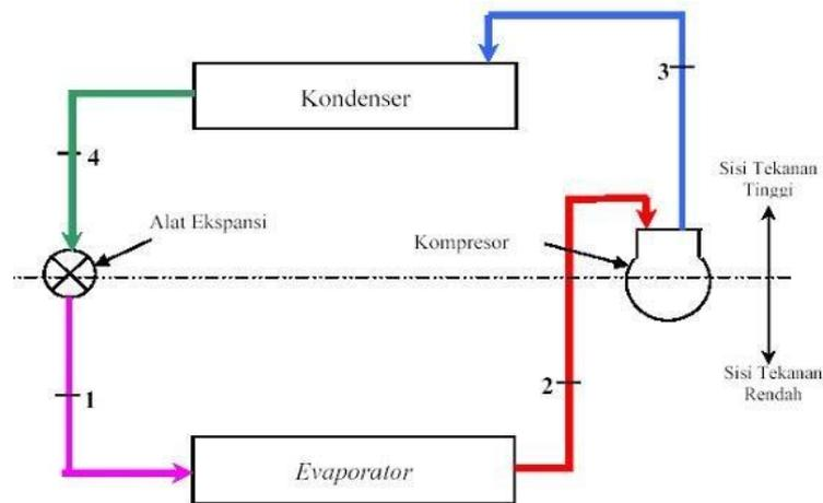
Gambar 2. Sistem Refrigerasi Kompresi
