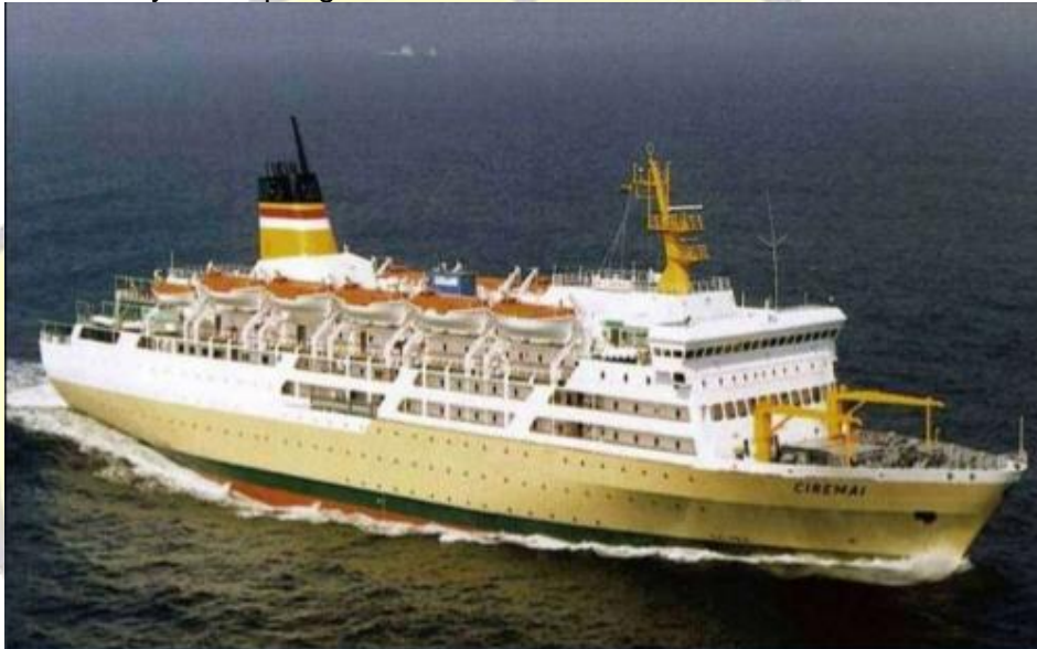
Gambar 1. Kapal Penumpang Barang 850 DWT
