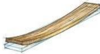
Gambar 3.1. Kayu Retak dan Melengkung
