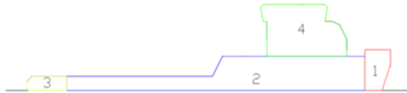
Gambar 2. Luas Tangkap Angin Pada Kapal
