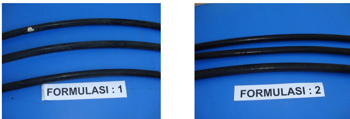
Gambar 1. Hasil ekstruksi tube (kelongsong kabel) formula 1 dan 2
