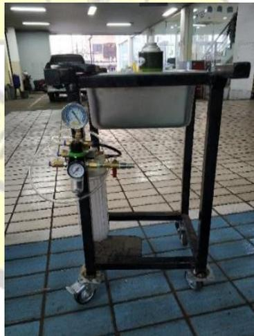
Gambar 3. Hasil perancangan mesin *bleeding*
