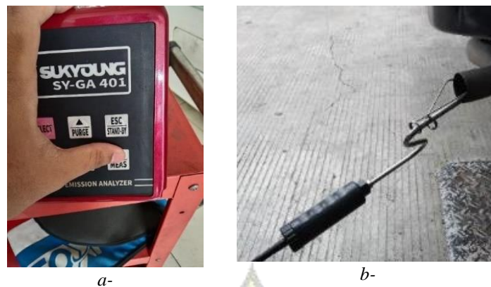
Gambar 4. Gambaran uji emisi: a- emission analyser; b- sensor pada knalpot
