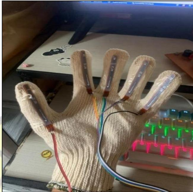
Gambar 3. Sarung tangan yang di lengkapi sensor flex
