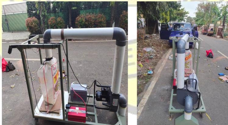
Gambar 18. Alat penyedot gabah kering
