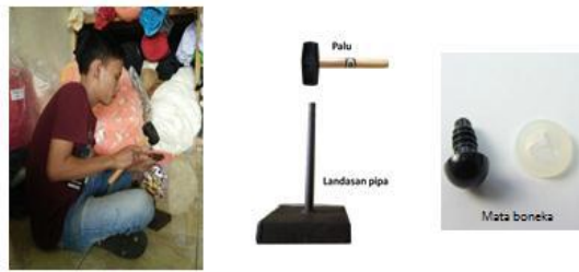
Gambar 4.2 Pemasangan Mata Boneka
