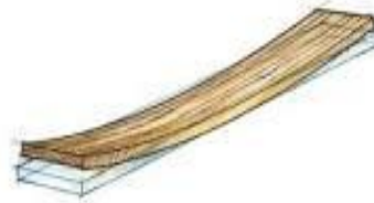
Gambar 3.1. Kayu Retak dan Melengkung
