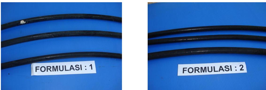
Gambar 1. Hasil ekstruksi tube (kelongsong kabel) formula 1 dan 2
