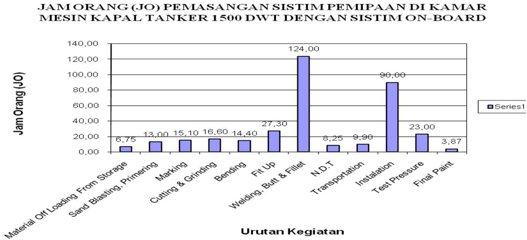
Gambar 6. Jam orang pemasangan sistem pemipaan di kamar mesin kapal Tanker 1500 DWT dengan sistem on
