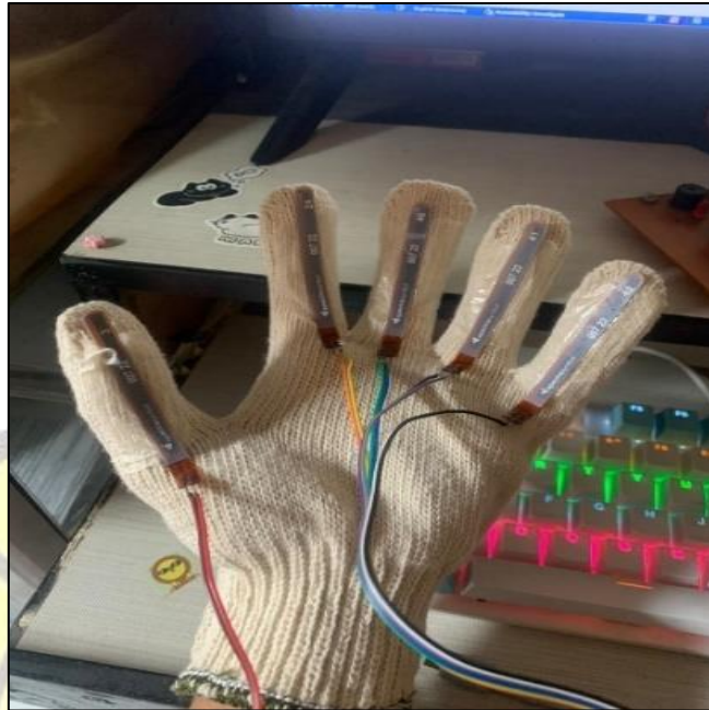
Gambar 3. Sarung tangan yang di lengkapi sensor flex
