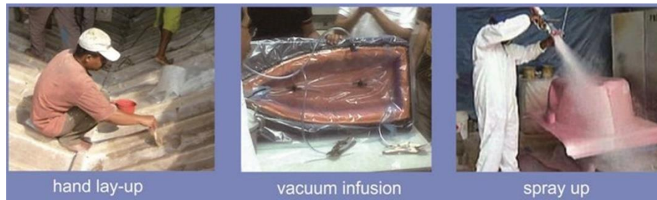
Gambar 2. Metode Pencetakan FRP
